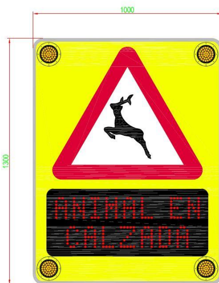
Modelo de señal preaviso P-22 + Texto ANIMAL EN CALZADA empleado Arcón cerrado de aluminio E60, LEDs intemperie IP68
